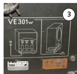
Auf der Rückwand vom Volksempfänger: Eine Zeichnung zeigt rechts, wie eine Hochantenne angeschlossen wird. Der Anschluss für »Erde« wird an die Wasserleitung geführt.
